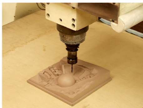
NC モデリングマシンによる 掘削作業
